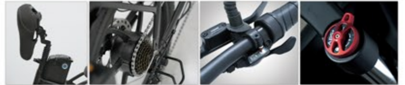
開閉式サドル ホイールインモーター シマノ7段ギア ABS高性能サス
